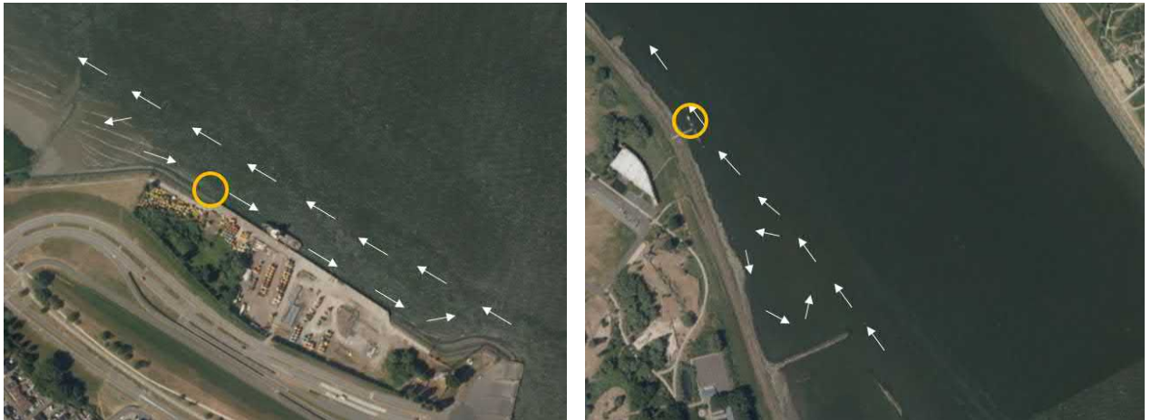
Figuur 20 Inschatting stromingspatronen bij afgaand tij op de locatie van het RWS steunpunt te Rozenburg (boven) en bij het ponton van de Watertaxi Rozenburg (onder). De meetpunten bevinden zicht binnen de aangegeven cirkel. (bron afbeelding: Esri Nederland, beeldmateriaal.nl).
