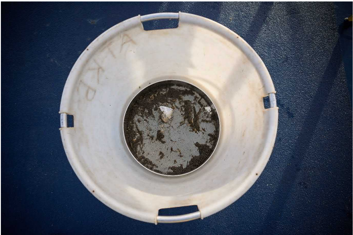
Foto 10 Het residu met daarin het plastic, dat achterblijft op de zeef (foto P. Nijhuis).
